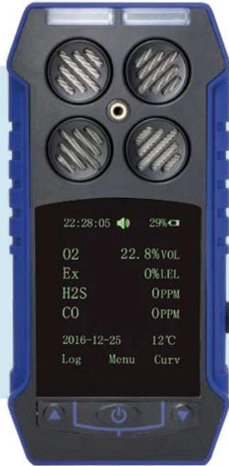
El detector portátil de múltiples gases MG-BH4S puede detectar gases combustibles, O<sub>2</sub> y otros dos tipos de gases tóxicos de forma continua y simultánea. Es ampliamente utilizado en el área donde se requiere protección contra explosiones o fugas de gases tóxicos, como canales subterráneos o industria minera, para proteger la vida de los trabajadores y evitar daños en los equipos pertinentes
