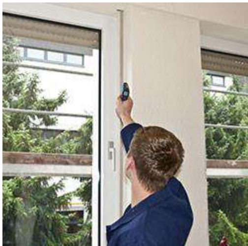
Uso práctico del termómetro sin contacto en una ventana.
